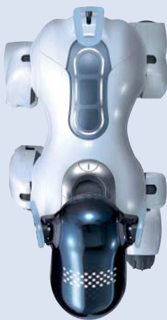
Aibo: Für die Programmierung der Aktionen des Roboter-Hundes wurde erstmals ein Modell aus der Verhaltensforschung verwendet
