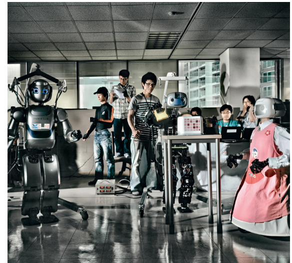
Der Mahru (rechts) wurde am Korean Institute of Science and Technology als Haushaltshilfe entwickelt. Er kann Geschirr wegräumen, waschen und sogar kochen – ebenso wie der PR2 der Firma Willow Garage (links)
