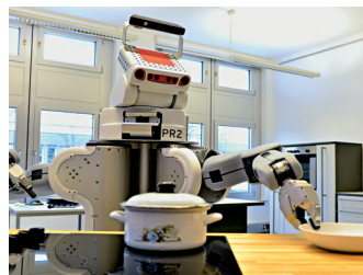
Der Mahru (rechts) wurde am Korean Institute of Science and Technology als Haushaltshilfe entwickelt. Er kann Geschirr wegräumen, waschen und sogar kochen – ebenso wie der PR2 der Firma Willow Garage (links)
