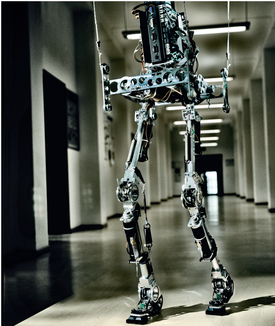
Der BioBiped 1 von der TU Darmstadt ist nur eines von vielen Projekten weltweit, die humanoiden Robotern den aufrechten Gang beibringen wollen
